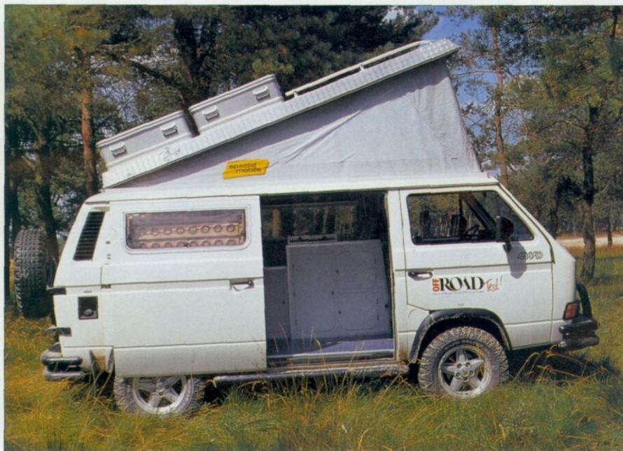
Drei große, mit Moskitonetzen versehene Öffnungen in den Seitenwänden des Aufstellsdaches sorgen für gute Belüftung des Fahrzeuginnenraums. Das Klappdach selbst nimmt Lasten bis zu 100 kg Gewicht pistonfest auf, dabei können empfindliche und wertvollere Gegenstände in den beiden wasserdichten und verschließbaren Aluboxen untergebracht werden. Unter dem aufgestellten Aluminium-Dach finden zwei Personen in einem 201 x 120 cm großen Bett ihre Nachtruhe
